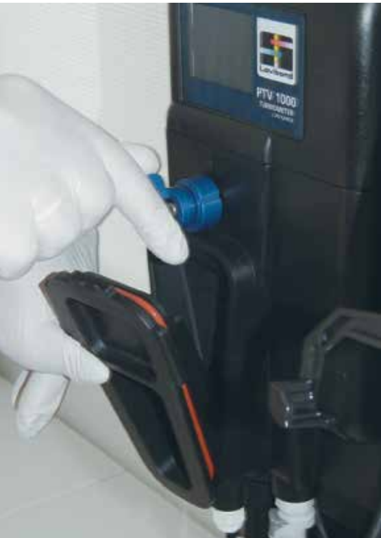
2 Die neu entwickelte Luftblasen-Falle ermöglicht den einfachen Zugriff von der Geräte-Frontseite.
