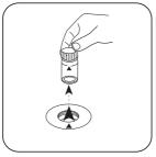
Küvette aus dem Messschacht nehmen.
