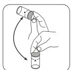
Tablette(n) durch Umschwenken lösen.
