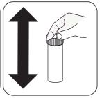
Das Teströhrchen mit dem Deckel verschließen und den Inhalt durch kräftiges Schüteln für 1 Minute mischen.
