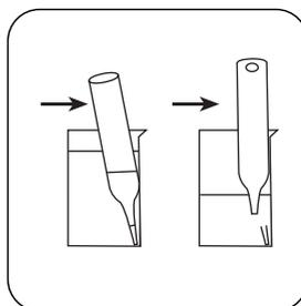
Eine Vacu-vial® Ampulle im Probengefäß platzieren. Die Ampullenspitze durch leichtes Drücken gegen die Gefäßwand abbrechen. Die komplette Füllung der Ampulle abwarten.
