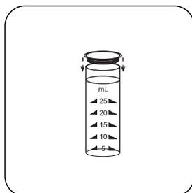
Das Probenglas mit dem Deckel verschließen.
