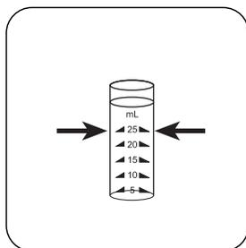
Das Probenglas bis zur 25-mL-Markierung mit der Probe füllen.
