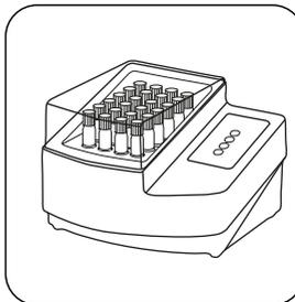
Die Küvette für **120 Minuten bei 120 °C** im vorgeheizten Thermoreaktor **auf dem Kopf stehen** erwärmen.
