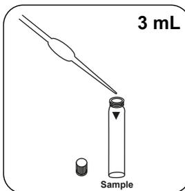
**3 mL Probe** in die Probenküvette geben.
