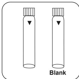
Zwei **Reagenzküvetten** bereitstellen. Eine als Nullküvette kennzeichnen.
