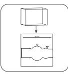
Die **Probenküvette** in den Messschacht stellen. Positionierung beachten.
