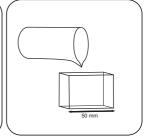
Eine 50-mm-Küvette mit Probe füllen.
