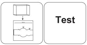
Die **Probenküvette** in den Messschacht stellen. Positionierung beachten.
