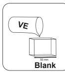
50-mm-Küvette mit VE-Wasser füllen.
