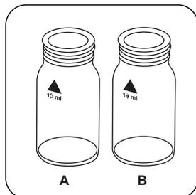
Zwei saubere 24-mm-Küvetten bereitstellen. Eine als Ammoniakküvette, die andere als Chloraminküvette kennzeichnen.
