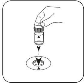
Die Chloramine **Küvette** in den Messschacht stellen. Positionierung beachten.
