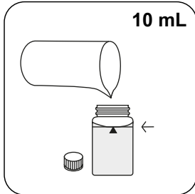
24-mm-Küvette mit 10 mL Probe füllen.
