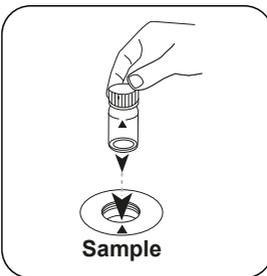
Die **Probenküvette** in den Messschacht stellen. Positionierung beachten.
