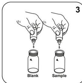
In jede Küvette **3 Tropfen Chloride-51 Lösung** geben.
