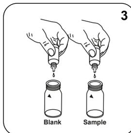
In jede Küvette **3 Tropfen Chloride-52 Lösung** geben.
