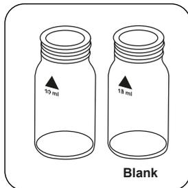
Zwei saubere 24-mm-Küvetten bereitstellen. Eine als Nullküvette kennzeichnen.
