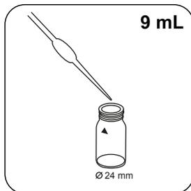
24 mm-Küvette mit **9 mL VE-Wasser** füllen.
