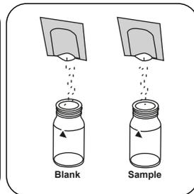
Immettere **una bustina di polvere CU2 Porphyrin F10** in ogni cuvetta.
