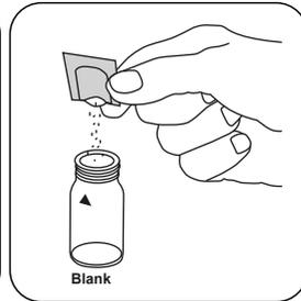
Immettere **una bustina di polvere CU3 Masking F10** nella cuvetta zero.
