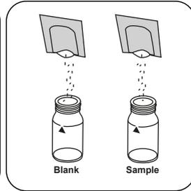
Immettere **una bustina di polvere CU1 Porphyrin F10** in ogni cuvetta.
