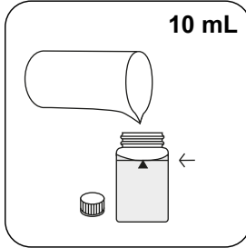
24-mm-Küvette mit 10 mL Probe füllen.
