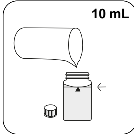
24-mm-Küvette mit 10 mL Probe füllen.
