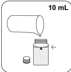
24-mm-Küvette mit 10 mL Probe füllen.
