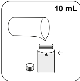
10 mL 24-mm-Küvette mit 10 mL Probe füllen.
