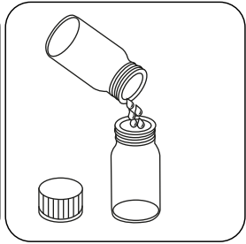
Die vorbereitete Glycinlösung in die vorbereitete Küvette füllen.
