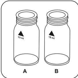
Zwei saubere 24-mm-Küvetten bereitstellen. Eine als Nullküvette, die andere als Probenküvette kennzeichnen.
