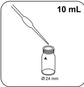
**Exakt 10 mL Probe** in die Probenküvette geben.
