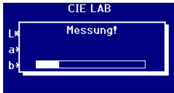
Die Fortschrittsanzeige zeigt den Status der Messung an. Nach Abschluss der Messung wird das Ergebnis am Bildschirm angezeigt.
