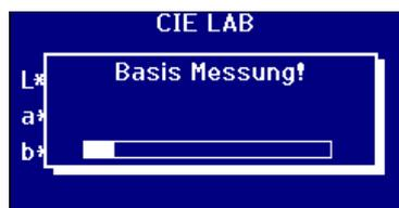
Nach Abschluss der Basislinienmessung wird am Instrument wieder das Display angezeigt, das vor Drücken der Taste [NULL] **ZERO** aktiviert wurde.
