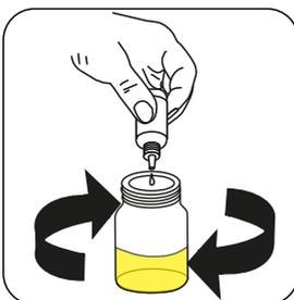
**Chlor LR Titrierlösung CL4 oder Chlor HR Titrierlösung CL5** tropfenweise der Probe zugeben bis die Färbung von **orange/braun** bis **hellgelb** umschlägt.
