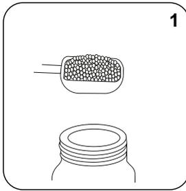
**1 Messlöffel Peroxyessigsäure Indikator CL2B Pulver zugeben.**
