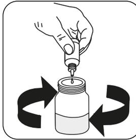
**Chlor LR Titrierlösung CL4 oder Chlor LR Titrierlösung CL5** tropfenweise der Probe zugeben bis die Verfärbung von **blau** nach **farblos** umschlägt.
