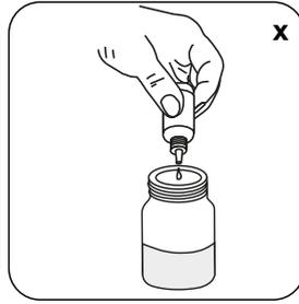
Ajouter **X** gouttes **x** de réactif à l'échantillon, en fonction du volume d'échantillon sélectionné (voir tableau dans les notes).
