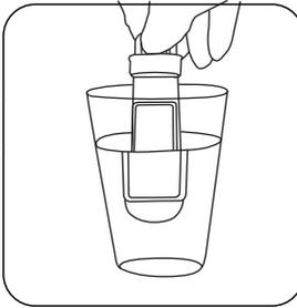
Échantillonnage de liquides : L'échantillon est prélevé en plongeant les deux côtés de la palette dans le liquide à tester.
