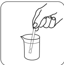
Plonger la bandelette réactive dans la solution à tester de manière à ce qu'elle soit complètement immergée.
