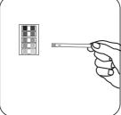
Lire le résultat sur l'échelle de couleurs. (En présence d'ions nitrate, le papier test extérieur (à l'extrémité du bâtonnet) se colore en rouge-violet. La zone de test située au-dessus (vers l'extrémité de la poignée) indique la concentration de nitrites.)
