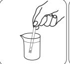
Plongez la bandelette dans la solution à tester de manière à ce que toutes les pastilles soient complètement immergées. (1 seconde)
