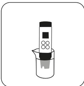
Mantenga el medidor sin la tapa protectora en el agua de la muestra que se va a medir, de modo que el electrodo y la sonda de temperatura queden sumergidos en el agua de la muestra a una altura no superior a la del anillo de estanqueidad.
