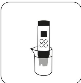
Segurar o aparelho de teste sem a tampa de proteção na água da amostra a ser medida, de modo a que o eletrodo e a sonda de temperatura fiquem imersos na água da amostra não acima do anel de vedação.
