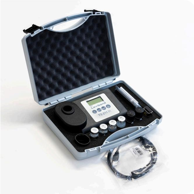
Das kompakte Lovibond® Infrarot-Trübungsmessgerät TB 211 IR für die schnelle und exakte Vor-Ort-Analyse. Gemessen wird, wie in der EN ISO 7027 vorgesehen, das Streulicht im Winkel von 90°.
