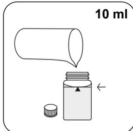
Remplissez une cuvette de PTSA mm de **10 ml d'échantillon**.
