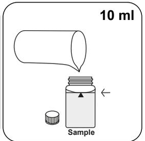
Versez **10 ml d'échantillon fractionné, préparé** dans la cuvette réservée à l'échantillon.
