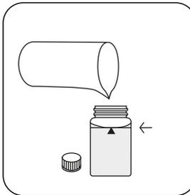
Remplissez la cuvette jusqu'au **repère de 10 ml** en y versant l'**eau déminéralisée**.
