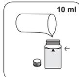
Remplissez une cuvette de 24 mm de **10 ml d'échantillon**.
