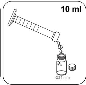
Versez **10 ml d'échantillon** dans la cuvette réservée à l'échantillon.
