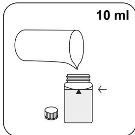
Remplissez une cuvette de Fluorescéine mm de **10 ml d'échantillon**.
