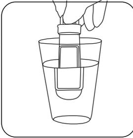
Probenahme von Flüssigkeiten: Die Probe wird entnommen, indem beide Seiten des Paddels in die zu untersuchende Flüssigkeit getaucht werden.
