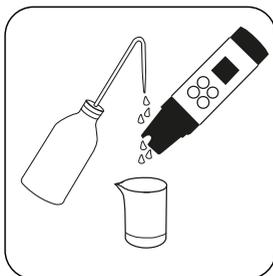
Enxaguar o eletrodo com água destilada ou desionizada e limpar cuidadosamente com uma toalha de papel.
