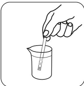
Mergulhar a tira de teste na solução a testar, de modo a que todas as almofadas fiquem completamente imersas.
