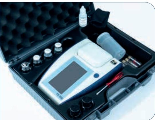
Tómelo o déjelo: El turbidímetro TB350 es ideal para su uso portátil en aplicaciones de campo como la monitorización de sistemas de distribución de agua y laboratorios que analizan una amplia gama de muestras.
