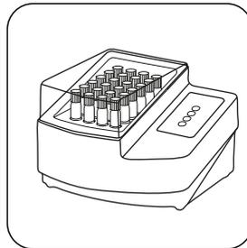
Disgregar la(s) cubeta(s) en el termoreactor precalentado durante **30 minutos a 100 °C** .
