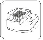
在预热的热反应器中,在 100℃ 下密封比色杯 30 分钟
