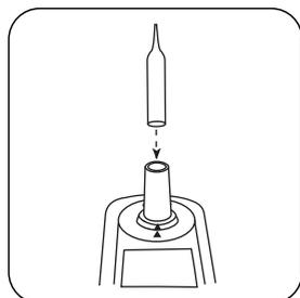
Posizionare la **fiala zero** nel vano di misurazione.
