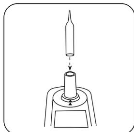
Posizionare la fiala nel vano di misurazione.
