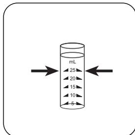
Наполните проботборное стекло пробой до отметки 25 мл.
