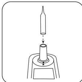
Выньте нулевую ампулу из измерительной шахты.
