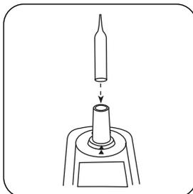
Выньте нулевую ампулу из измерительной шахты.
