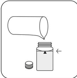
Küvette bis zur **10-mL-Marke** mit **VE-Wasser** auffüllen.
