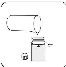
Encher a célula até à **marca de 10 mL** com **água desmineralizada**.
