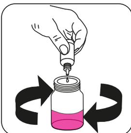
Ajoutez au goutte à goutte **Hydrogen Peroxide HR Titrant HP2 ou Hydrogen Peroxide LR Titrant HP3** au échantillon jusqu'à obtention d'une coloration **incolore à rose**.
