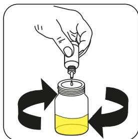
Añadir gota a gota **Alkalinity LR Titrante TA3** o **Alkalinity HR Titrante PA2/TA2** en la muestra hasta que adquiera una coloración de **violeta a amarillo pálido**.
