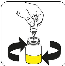
Añadir gota a gota **Alkalinity LR Titrate TA3** o **Alkalinity HR Titrate PA2/TA2** en la muestra hasta que adquiera una coloración de **violeta a amarillo**.
