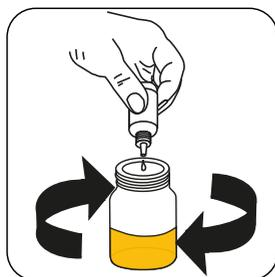
Añadir gota a gota **Alkalinity LR Titrante TA3** o **Alkalinity HR Titrante PA2/TA2** en la muestra hasta que adquiera una coloración de **azul a naranja/amarillo**.
