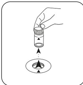
Prelevare la cuvetta dal vano di misurazione.
