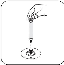
Posizionare la cuvetta zero in dotazione (etichetta rossa) nel vano di misurazione. Fare attenzione al posizionamento.
