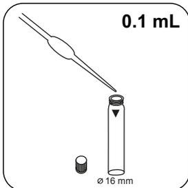
Aggiungere **0.1 mL (2 gocce) Phosphate-101** del campione sottoposto a digestione.
