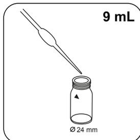
Riempire una cuvetta da 24 mm con **9 mL di acqua demineralizzata**.
