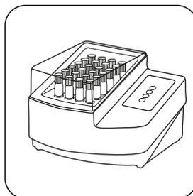
Scaldare la cuvetta per **120 minuti a 120 °C** nel termoreattore preriscaldato **in posizione capovolta**.
