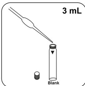
Immettere **3 mL del campione zero preparato** nella cuvetta zero.
