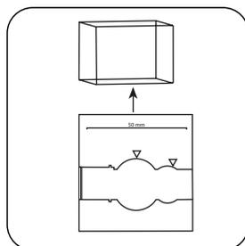
Prelevare la **cuvetta** dal vano di misurazione.
