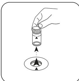
Prelevare la cuvetta dal vano di misurazione.
