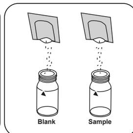
Immettere **una bustina di polvere Vario Ammonium Cyanurate F10** in ogni cuvetta.
