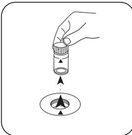
Prelevare la cuvetta dal vano di misurazione.
