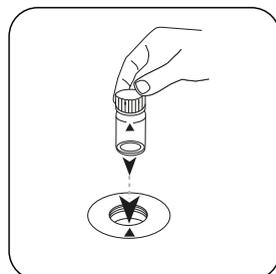
Posizionare la **cuvetta** Ammoniaca nel vano di misurazione. Fare attenzione al posizionamento.
