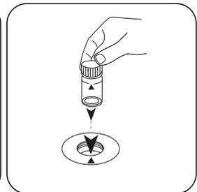
Posizionare la **cuvetta** Cloramina nel vano di misurazione. Fare attenzione al posizionamento.
