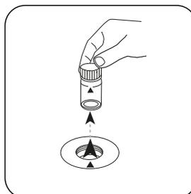
Prelevare la cuvetta dal vano di misurazione.
