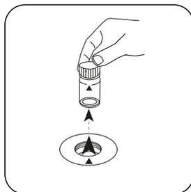
Prelevare la cuvetta dal vano di misurazione.
