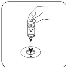
Posizionare la **cuvetta** Ammonia nel vano di misurazione. Fare attenzione al posizionamento.
