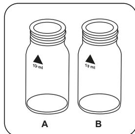
Preparare due cuvette pulite da 24 mm. Contrassegnare una cuvetta come Ammoniaca e l'altra come Cloramina.
