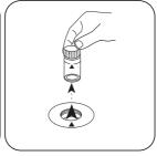
Prelevare la cuvetta dal vano di misurazione.
