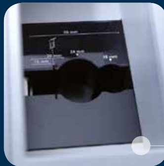
Pozzetto della cuvetta multifunzionale
