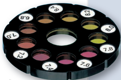
Colore disco con standard di vetro resistente al colore
