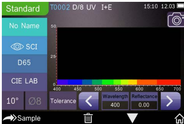
Abb. 11 Reflexionsgrad der Standardmessung
