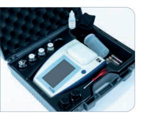
Tragbar im Koffer oder an einem festen Arbeitsplatz: Das Trübungsmessgerät TB350 ist ideal für den mobilen Einsatz vor Ort, z. B. für die Überwachung von Wasserverteilungssystemen, und für Labore, die eine Vielzahl von Proben untersuchen.
