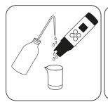
Sciacquare l'elettrodo con acqua distillata o deionizzata e tamponare accuratamente con un panno di carta.
