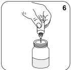
Añadir 6 gotas de Free Chlorine Buffer FCL1. Nota: Añadir 10 gotas cuando la dureza de la muestra sea superior a 400 mg/l (como CaCO<sub>3</sub>).
