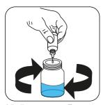
Añadir gota a gota Free Chlorine LR Titrant FCL2 o Free Chlorine HR Titrant FCL3 en la muestra hasta que adquiera una coloración de incoloro / amarillo pálido a azul.
