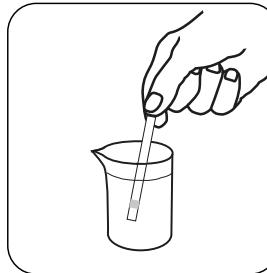
Sumerja la tira reactiva en la solución a analizar de forma que la almohadilla quede completamente sumergida.
